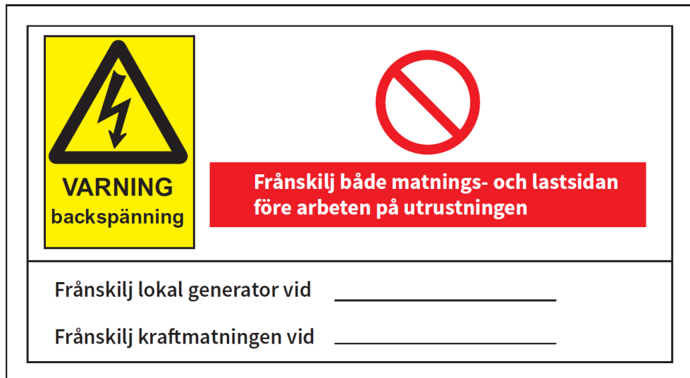
Figur 20 Varningsskylt för nätsidan i byggnad med solcellsanläggning.
